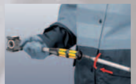
Hier kann die Verlängerung für eine bessere Hebelwirkung eingesetzt werden
