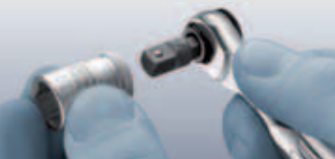
Mit dem Wera Adapter 870/1 ist auch der Einsatz von 1/4"-Nüssen möglich.
