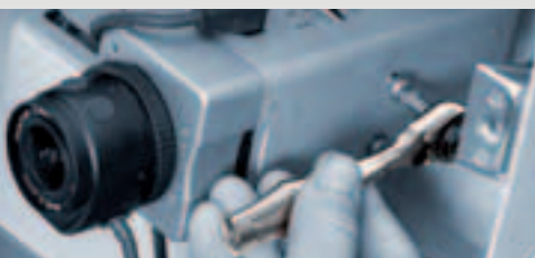
Durch das Drehen des Rändelrads mit dem Daumen lässt sich der Schraubvorgang beschleunigen.
