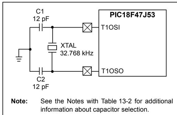
**TABLE 13-2: CAPACITOR SELECTION FOR THE TIMER OSCILLATOR<sup>(2,3,4,5)</sup>**
