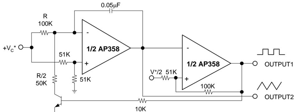
\*WIDE CONTROL VOLTAGE RANGE:  $0 V_{DC} \leq V_C \leq 2 (V^+ - 1.5V_{DC})$
