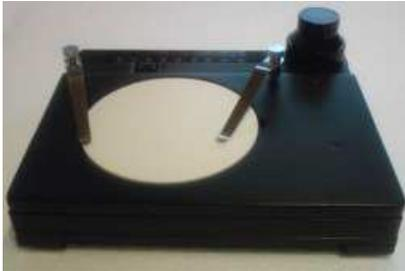
Aufsetzbarer Präzisions-Kreuztisch, Tischplatte 180 x 155 mm. Bewegung mittels horizontal montierten, coaxialen Triebknöpfen. Mit Teilung. Passend für alle Stative.
