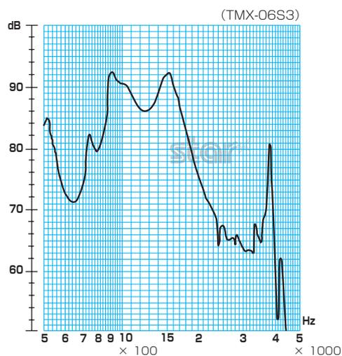
※条件/印加電圧:6V、矩形波:1/2 duty、距離:10cm
