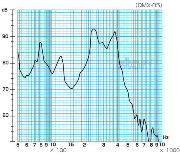
※条件/印加電圧:5V、矩形波:1/2 duty、距離:10cm
