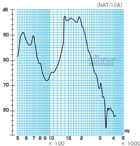
※条件/印加電圧: 12V、矩形波: 1/2 duty、距離: 10cm
