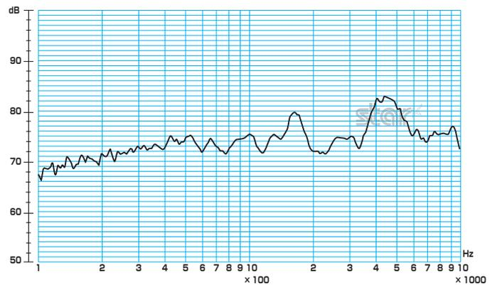
※条件/印加電圧:3.6V、矩形波:1/2 duty、距離:10cm 推奨キャビティ使用
