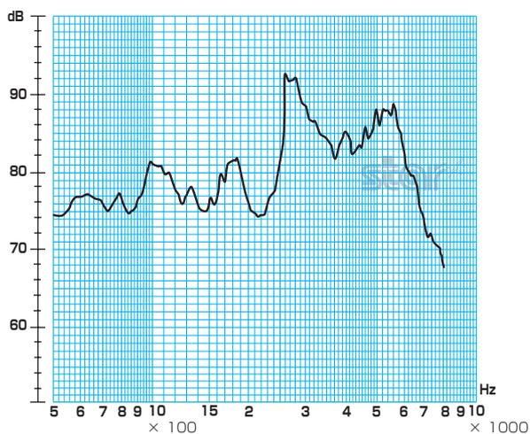
※条件/印加電圧:3.6V、矩形波:1/2 duty、距離:10cm
