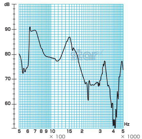
※条件/印加電圧: 5V、矩形波: 1/2 duty、距離: 10cm
