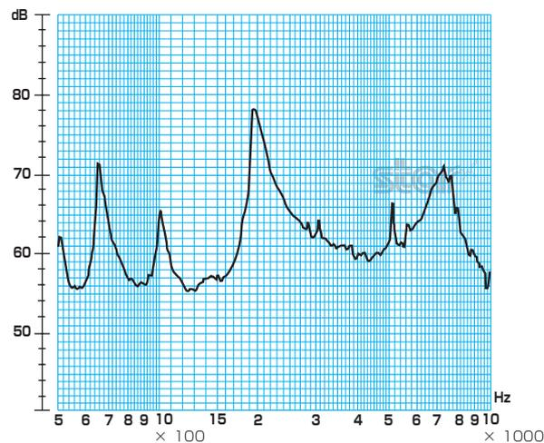
※条件/印加電圧:1.5V、矩形波:1/2 duty、距離:10cm
