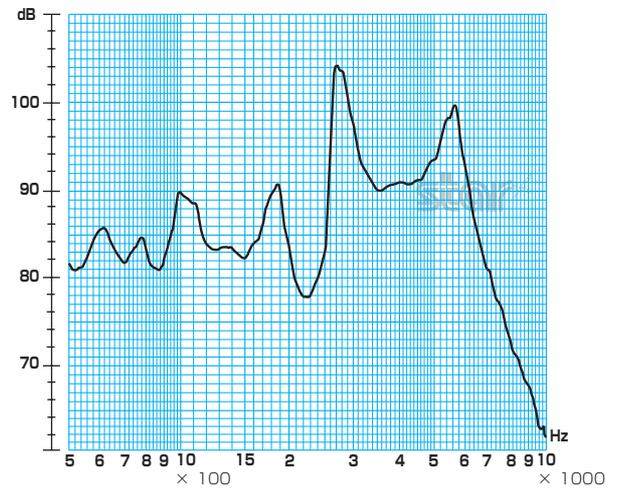
※条件/印加電圧:3.6V、矩形波:1/2 duty、距離:10cm 推奨キャビティ使用
