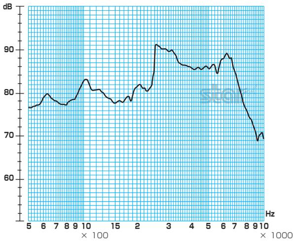
※条件/印加電圧:3.6V、矩形波:1/2 duty、距離:10cm
