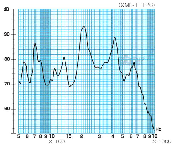
※条件/印加電圧: 5V、矩形波: 1/2 duty、距離: 10cm
