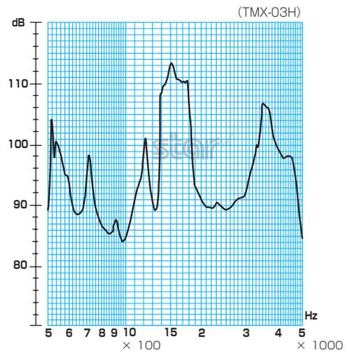
※条件/印加電圧: 12V、矩形波: 1/2 duty、距離: 10cm
