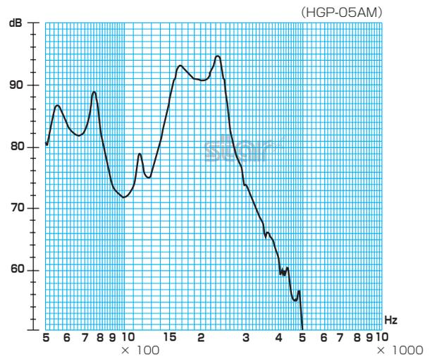
※条件/印加電圧:5V、矩形波:1/2 duty、距離:10cm
