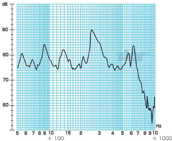
※条件/印加電圧: 1.5V、矩形波: 1/2 duty、距離: 10cm
