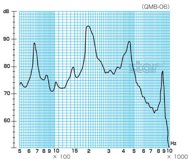
※条件/印加電圧:6V、矩形波:1/2 duty、距離:10cm
