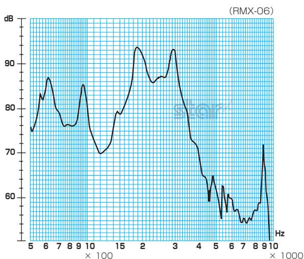
※条件/印加電圧:6V、矩形波:1/2 duty、距離:10cm
