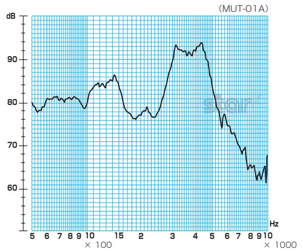
※条件/印加電圧:1.5V、矩形波:1/2 duty、距離:10cm
