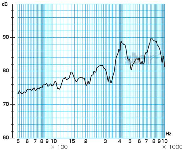
※条件/印加電圧:3V、矩形波:1/2 duty、距離:10cm 推奨キャビティ使用
