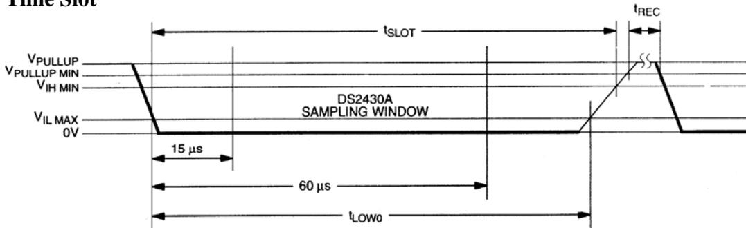
$60 \mu\text{s} \leq t_{\text{LOW0}} < t_{\text{SLOT}} < 120 \mu\text{s}$
