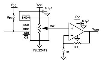
FIGURE 14. TYPICAL APPLICATION DIAGRAM FOR IMPLEMENTING ADJUSTABLE VOLTAGE REFERANCE
