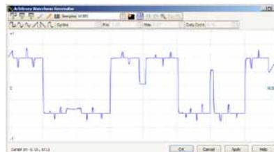
Todas las unidades incorporan un generador de funciones (sinusoidales, cuadradas, triangulares, nivel CC). Junto a controles básicos para ajustar el nivel, la desviación y la frecuencia, controles más avanzados permiten realizar
