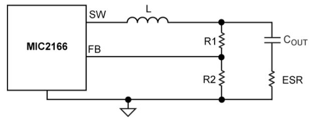
Figure 7a.  $\frac{R2}{R1+R2} \times \Delta V_{OUT} > 20mV$
