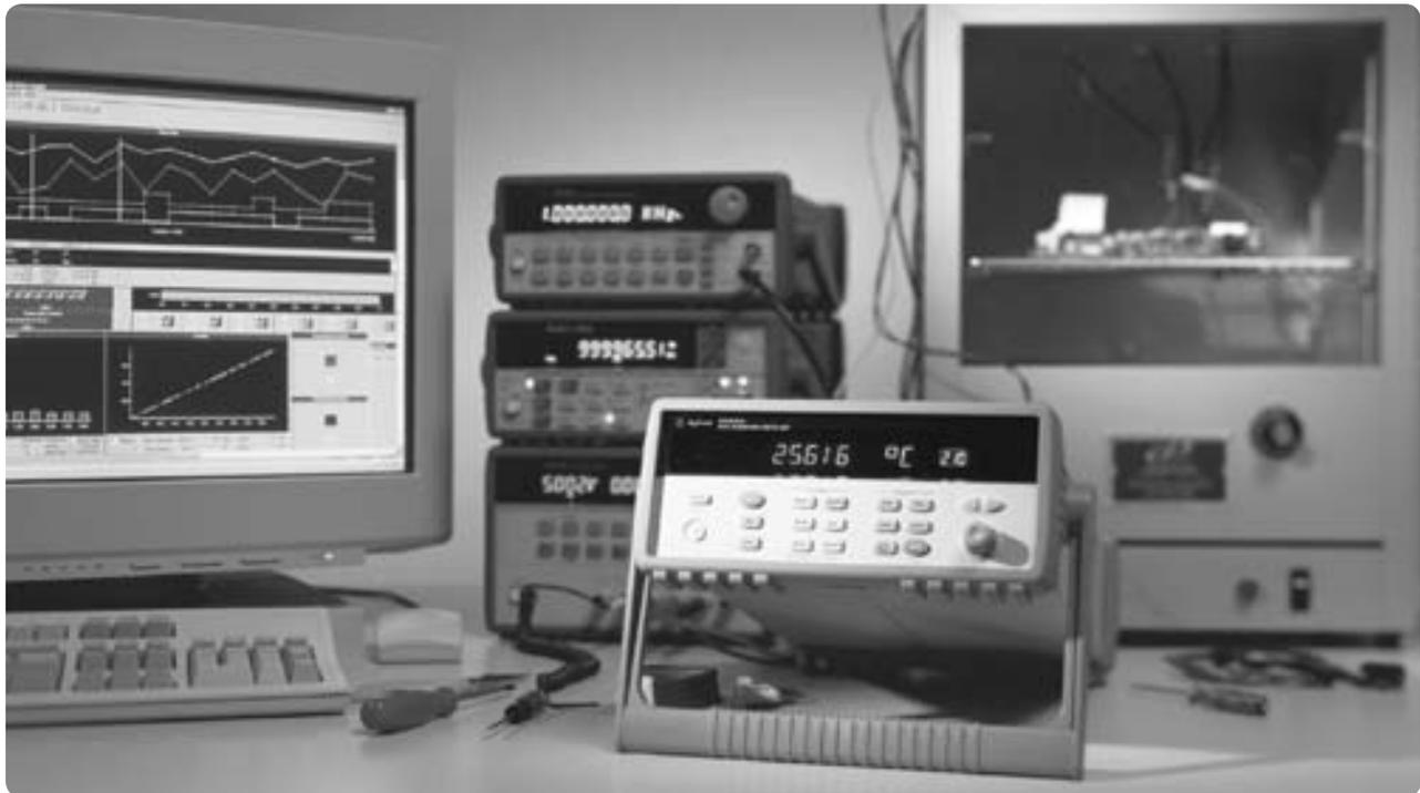
*Kompaktes 60-kanaliges Messdatenerfassungs-/Schalt-System*
