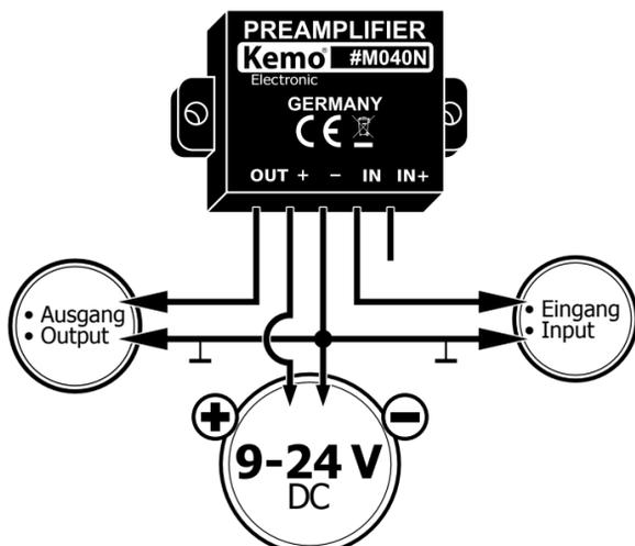
2. • Anschluss für Elektretmikrofone.
