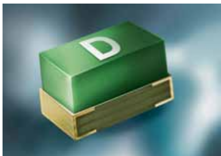
Abb. 5: Superflinke SMD-Sicherung USFF 1206, 3,2 mm x 1,6 mm, mit Nennströmen von 5 bis 250 mA
