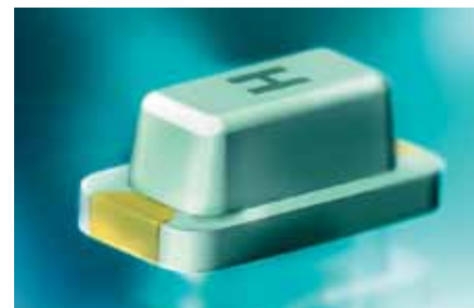
Abb. 4: Superflinke SMD-Sicherung USF 0402, 1,05 x 0,55 mm, mit Nennströmen von 375 mA bis 5 A
