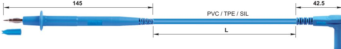
Hoch flexible Messleitungen mit PVC-, TPE oder Silicon-Isolierung. Eine Seite Ø 4 mm-Prüfspitze mit federnder Kontaktlamelle, andere Seite 90° abgewinkelte Ø 4 mm-Lamellenstecker mit starrer Isolierhülse. Durch den sehr hohen Isolationswiderstand der TPE-Isolierung eignet sich die Messleitung XPT-484 hervorragend für hochohmige Widerstandsmessungen. Lieferung mit Schutzkappe.
