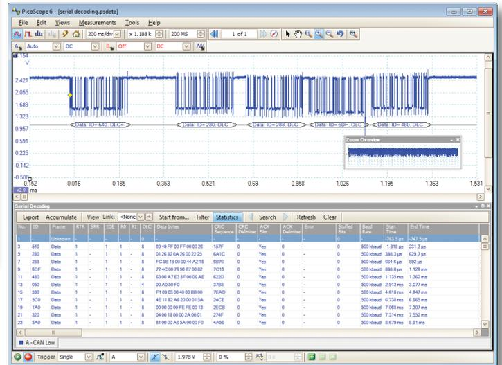
Los osciloscopios PicoScope serie 6000 son especialmente apropiados para la decodificación en serie, con un búfer de memoria profunda que les permite recopilar secuencias largas e ininterrumpidas de datos. Esto permite la captura de miles de estructuras o paquetes de datos durante varios segundos. Los osciloscopios pueden decodificar hasta cuatro buses a la vez con la selección de protocolo independiente para cada canal de entrada.
