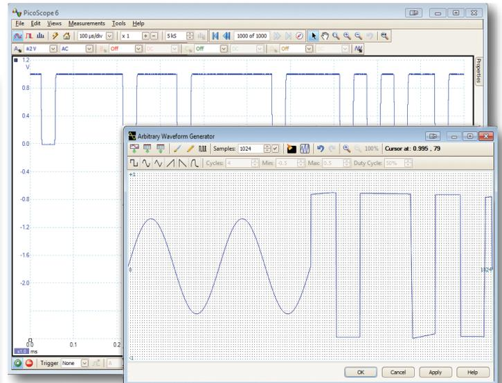
Cada modelo incluye un generador de funciones de CC a 20 MHz con formas de onda sinusoidales, cuadradas, triangulares y de CC. Los modelos D cuentan con un generador de formas de onda arbitrarias de 12 bits y 200 MS/s. Puede importar formas de onda arbitrarias desde archivos de datos, o crearlas y modificarlas con el editor AWG gráfico incorporado.
