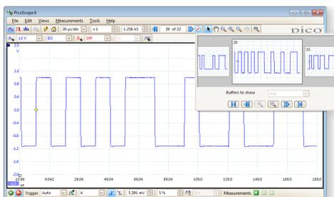
Para ayudarle a organizar el búfer, existe la opción de dividirlo en 10 000 segmentos accionados de forma individual. Utilice el navegador visual del búfer para desplazarse por los segmentos, o configure una máscara para filtrar las formas de onda que más le interesen.
