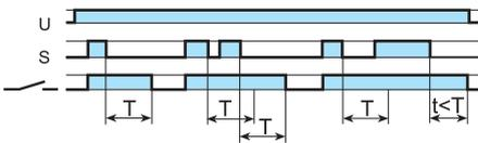
**(BE) Off-delay with control signal.**
