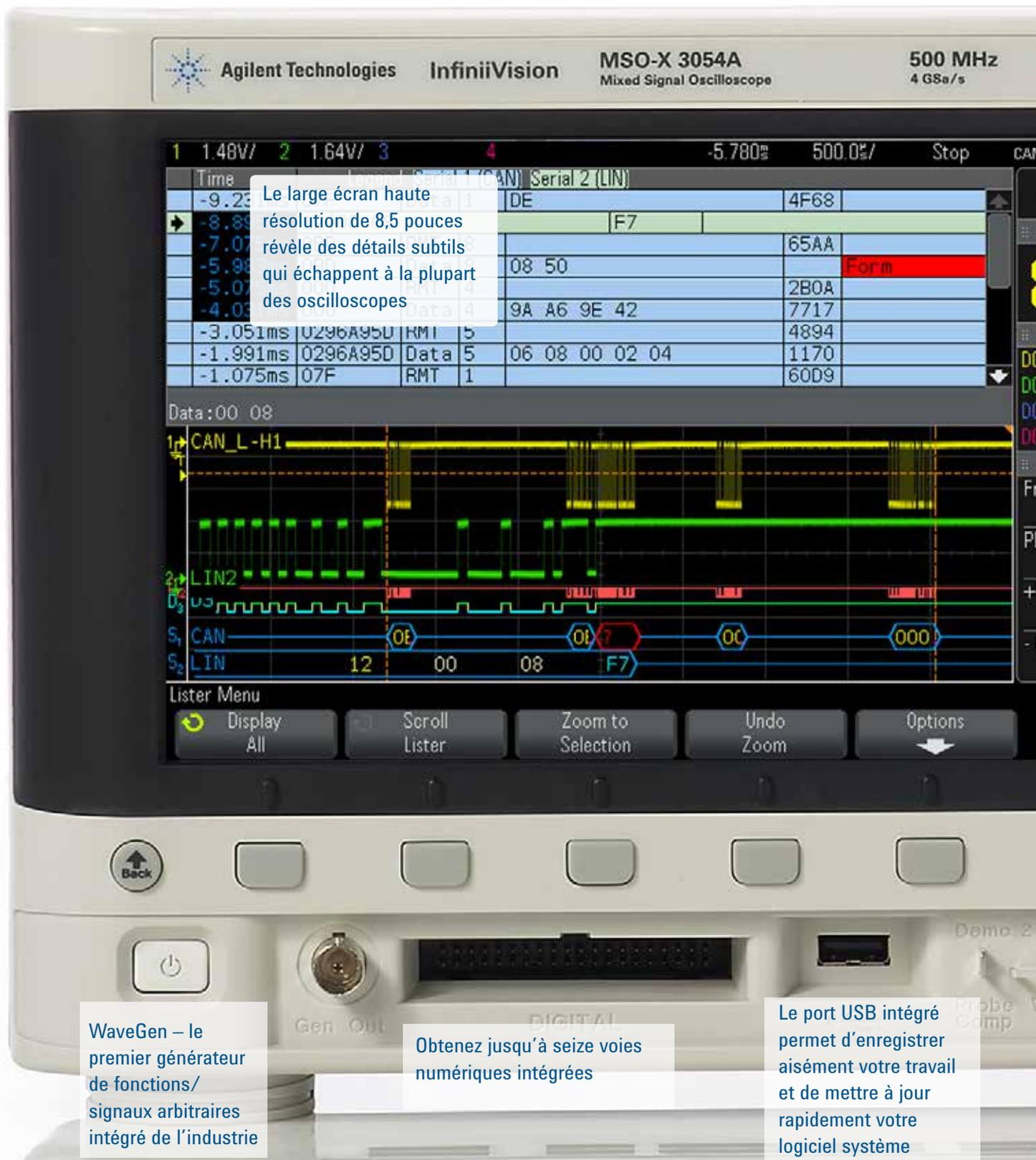
Les commandes de recherche et navigation du panneau avant facilitent la lecture, l'arrêt, le retour arrière et l'avance rapide des signaux
