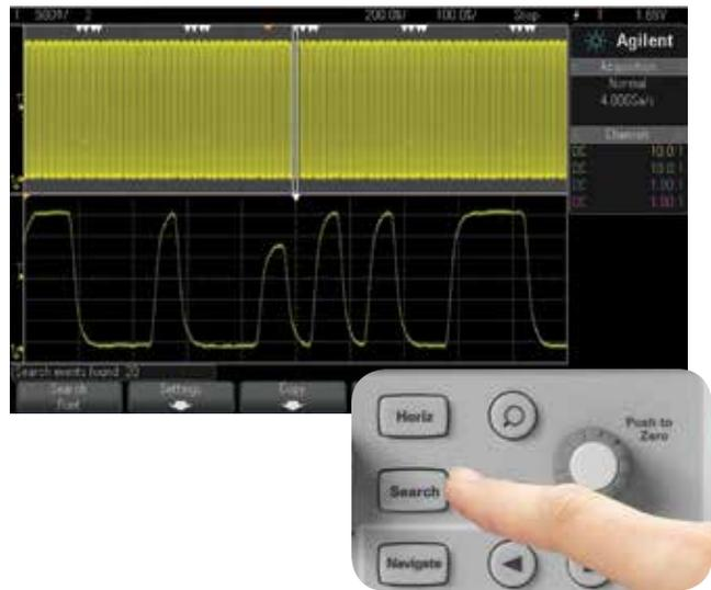
Dans l'exemple ci-contre à droite, l'oscilloscope a été configuré pour capturer une étendue temporelle de 1 milliseconde dans un flux de données numériques complexes. La fonction recherche & navigation a permis à l'oscilloscope de trouver jusqu'à 20 occurrences d'impulsions « parasites », de les marquer (des triangles blancs marquent l'emplacement de chaque parasite) et d'y accéder rapidement.
