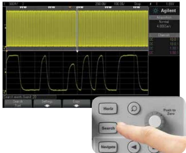
Nell'esempio mostrato nella videata qui sulla destra, l'oscilloscopio era stato impostato per catturare un intervallo di 1 ms di un complesso segnale di comunicazione digitale. Utilizzando le funzioni di ricerca e navigazione, l'oscilloscopio ha trovato e marcato (i triangoli bianchi mostrano la posizione di ogni runt) gli impulsi anomali di tipo "runt", tra le cui 20 occorrenze si può rapidamente navigare usando i pulsanti.
