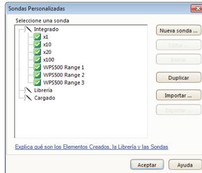
El menú personalizado de las sondas le permite corregir la ganancia, la atenuación, las desviaciones y las alineaciones de las sondas y los transductores o convertir los datos de forma de onda a diferentes unidades como corriente, tensión a escala, temperatura, presión, potencia o dB. Las definiciones se pueden
