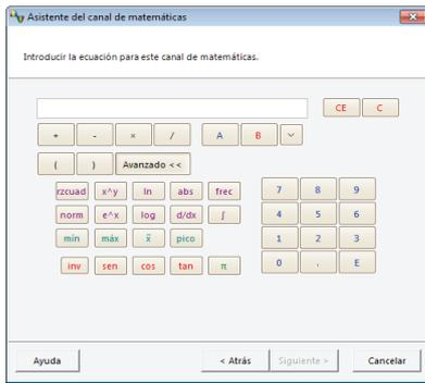
Con PicoScope 6, podrá realizar una gran variedad de cálculos matemáticos con las señales de entrada y formas de onda de referencia.
