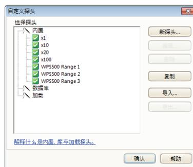
通过自定义探针菜单, 可以校正探针和传感器中的增益、衰减、偏移与非线性, 还可以将波形数据转换为不同的测量单位, 如电流、标定电压、温度、压力、功率或 dB。定义可以保存到磁盘以便日后使用。Pico 所提供标准示波器探针和电流钳的定义
