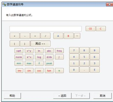
通过 PicoScope 6, 您可以针对输入信号和参考波形执行很多数学计算。
