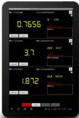
Abbildung 5. Mit Agilent Mobile Meter können Sie bis zu drei Multimeter-Messungen gleichzeitig überwachen.
