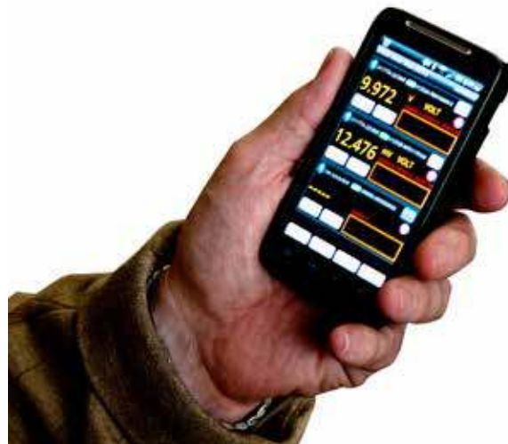
Abbildung 6: Beispiel für eine Messung mit dem Keysight Mobile Meter und einem Android-Smartphone.
