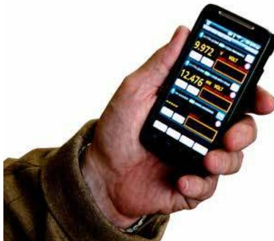
Figure 6. Realice medidas con el software Keysight Mobile Meter por medio de un teléfono inteligente Android
