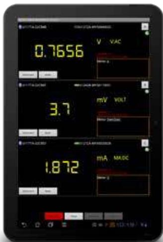
Figure 5. Keysight Mobile Meter visualizza fino a tre misure sui multimetri
