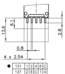
● kurzschließende Schaltweise / shorting switching mode
