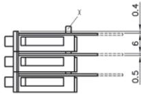
X Überstehende Steckzapfen bei Einbau entfernen.
