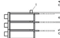
X Überstehende Steckzapfen bei Einbau entfernen.
