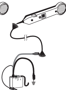
Figure 2b. Rastreamento de cabos
