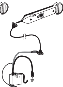
Figura 2b. Traccia del cavo
