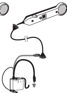
Figure 2b. Localisation d'un câble
