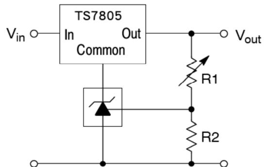
$$V_{out} = \left(1 + \frac{R1}{R2}\right) V_{ref}$$
