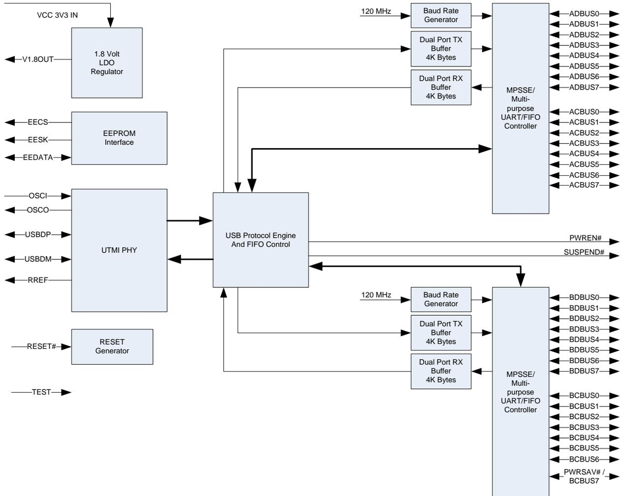
**Figure 2.1 FT2232H Block Diagram**
