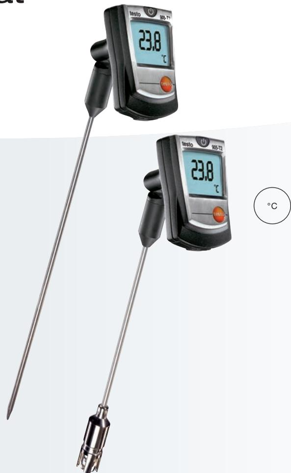
Das testo 905-T1 ist ein besonders schnelles Einstech-Thermometer mit einem weiten Messbereich von -50 bis +350°C, kurzzeitig sogar bis +500°C (1 bis 2 Minuten). Das Messgerät verfügt über einen professionellen Industrie-Sensor (Thermoelement Typ K). Besonders im oberen Messbereich weist es eine hervorragende Genauigkeit auf. Das testo 905-T2 ist ein Oberflächen-Thermometer mit weitem Messbereich von -50 bis +350°C, kurzzeitig sogar
