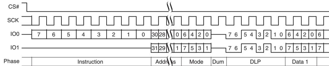
Figure 18. DDR Quad I/O Read
