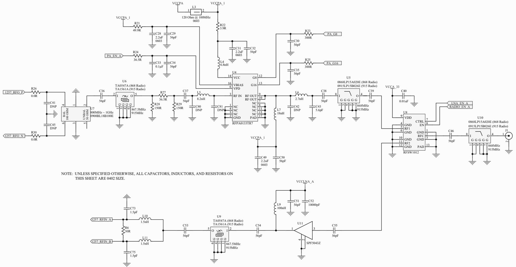
FIGURE A-6: LoRa® GATEWAY RADIO BOARD SCHEMATIC 3
