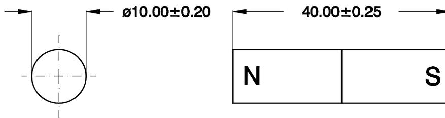
**Rundstabmagnet axial magnetisiert**
