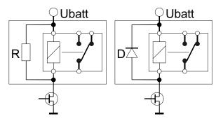
Fig. 7 Coil suppression circuits
