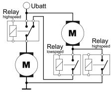
Fig. 6 Double fan circuit
