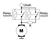
Fig. 5 Single fan circuit
