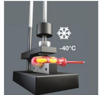
Le contrôle de la résistance au choc à froid (à  $-40^{\circ}\text{C}$ ) garantit la sécurité même dans les conditions d'utilisation extrêmes.
