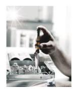
Aucune décharge électrostatique ne doit se produire lors du vissage composants électroniques (comme dans les smartphones ou les tablettes), puisqu'il risque de s'ensuivre des dysfonctionnements, voir des pannes. Des outils de vissage antistatiques s'avèrent donc indispensables.
