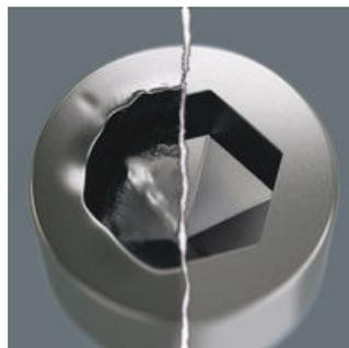
Le problème des vis à six pans creux tient à la minceur des surfaces d'appui sur lesquelles s'opère la transmission de la force depuis l'outil. Résultat : la tête de vis peut être endommagée. Les outils Hex-Plus possèdent des surfaces d'appui plus larges qui empêchent ce problème. Avec la possibilité, simultanément, de transmettre des couples jusqu'à 20 % supérieurs. Bon à savoir: les outils Hex-Plus s'utilisent sur toutes les vis à six pans creux standard !
