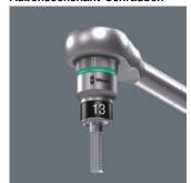
Die der Klemmung Außensechskant-Schraube im Steckschlüsseleinsatz wird durch zwei federnde Kugeln und einen dauerelastischen hochfesten Schrumpfschlauch gewährleistet. Dieser wird durch einen vorderen Stahlbund wirksam gegen mechanische Verletzungen geschützt. Besonders hilfreich in zugänglichen schwer Arbeitsbereichen, wo man die zweite Hand nicht zum Festhalten der Schraube nutzen kann.
