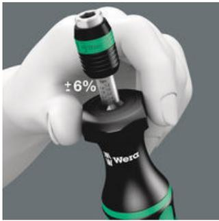
Messgenauigkeit  $\pm 6\%$  nach Norm DIN EN ISO 6789. Deutlich hör- und spürbares Überrasten beim Erreichen des eingestellten Drehmoments.
