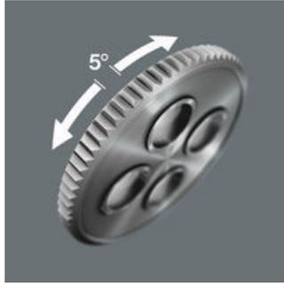
Die mit 72 Zähnen feinverzahnten Umschaltknarren haben einen niedrigen Rückschwenkwinkel von nur 5°. Der kleine Hub ermöglicht schnelles und präzises Arbeiten in allen Einbaulagen.
