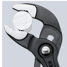
Los dientes desplazados con respecto al sentido de giro provocan un efecto de auto-retención y evitan el deslizamiento sobre la pieza.
