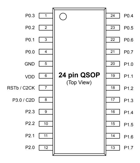
Figure 6.2. EFM8BB2x-QSOP24 Pinout
