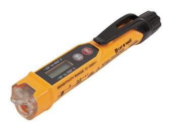
Le NCVT-4IR détermine la tension c.a. sans contact dans les câbles, les cordons, les disjoncteurs, les interrupteurs, les prises et les fils, et il fournit des mesures prises par un thermomètre à infrarouge, ce qui en fait le choix par excellence des professionnels de CVC.
