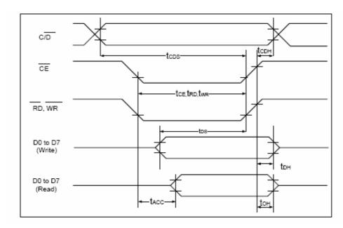
$(VDD=+5V\pm5\%,GND=0V,Ta=-20 \text{ to } +70^{\circ}C)$
