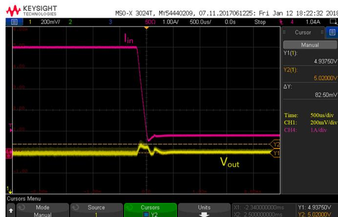
Figure 6.1. Si34061-ISO-FB EVB PD Output Step Load Transient Test
