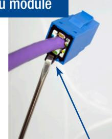
Pour le retirer, appuyez sur le loquet à l'aide d'un petit tournevis (ou de l'outil de dégagement de Belden) et tirez sur le câble.
