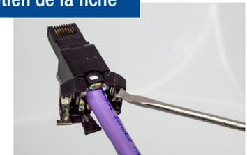
Pour la retirer, ouvrez les trappes arrière en serrant les broches supérieures et inférieures et en écartant les doigts. Soulevez le loquet à l'aide d'un petit tournevis (ou de l'outil de dégagement de Belden) et tirez sur le câble
