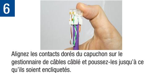
Alignez les contacts dorés du capuchon sur le gestionnaire de câbles câblé et poussez-les jusqu'à ce qu'ils soient encliquetés.
