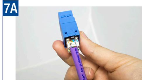
Alignez le loquet de la prise sur la petite bosse du gestionnaire de câbles et encliquez-le sur votre boîtier. Le module raccordé est maintenant prêt au test.
