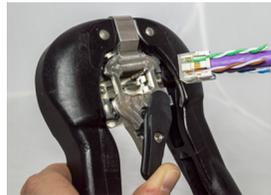
Insérez l'assemblage bien au fond de l'outil jusqu'au retour du levier
