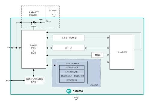
Figure 1. DS28E50 functional diagram
