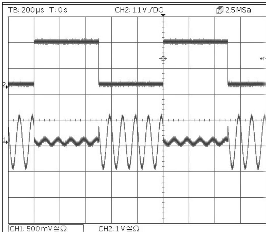
Notez que le deuxième tracé est la sortie de la prise Output 2 (Sortie 2) lorsque la voie 2 est synchronisée, qui suit le signal de la forme d'onde modulée.
