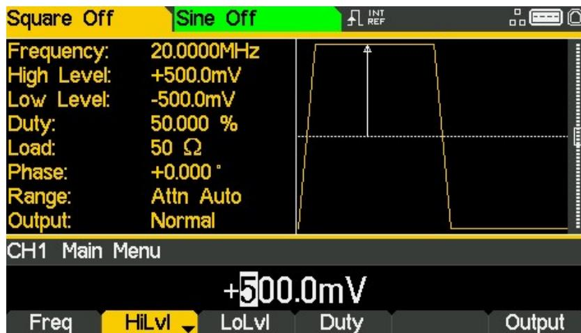
Advierta cómo las sucesivas pulsaciones de la tecla variable Ampl alternan las etiquetas Ampl y Offset (desplazamiento) con HiLvl (nivel alto) y LoLvl (nivel bajo) y viceversa.
