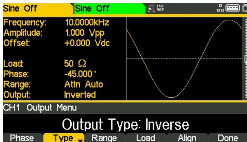
Beachten Sie, dass wiederholtes Drücken der Taste Type einen Wechsel zwischen normal und invertiert bewirkt.
