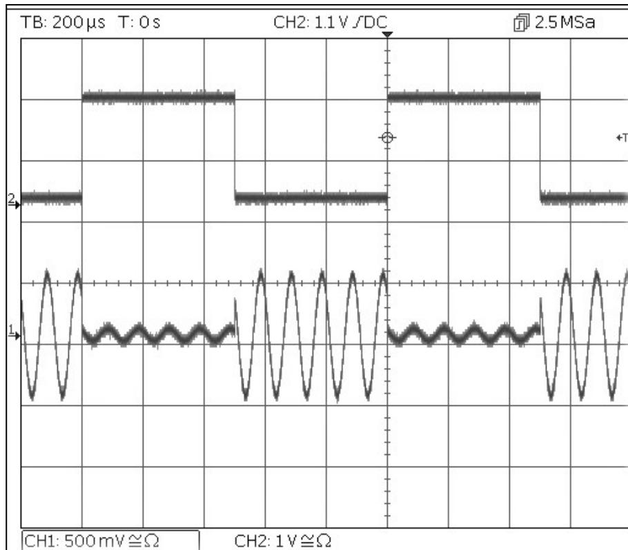
Beachten Sie, dass die zweite Messkurve das Ausgangssignal der Hauptbuchse von Ausgang 2 darstellt, wenn Kanal 2 synchronisiert ist und dem modulierenden Wellenformsignal folgt.
