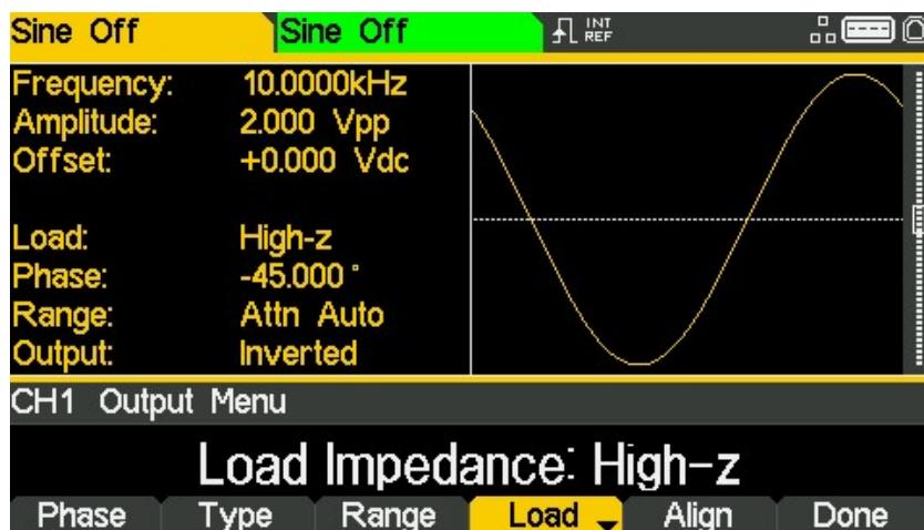
Advierta que, aunque el valor por defecto de la impedancia de carga es 50 ohmios, puede cambiarse a cualquier otro entre 50 y 10.000 ohmios. Los niveles se calculan en función de esta impedancia.
