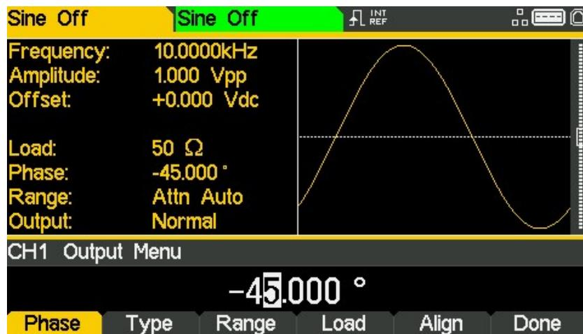
L'angolo di fase impostato è il punto nel periodo della forma d'onda che coincide con il fronte di sincronizzazione o di generazione, ovvero il punto in cui si origina la forma d'onda. Quindi, un'impostazione negativa della fase anticipa la forma d'onda in relazione alla sincronizzazione o alla generazione, mentre un'impostazione positiva la ritarda. La forma d'onda nella casella grafica cambia per riflettere questo fenomeno.
