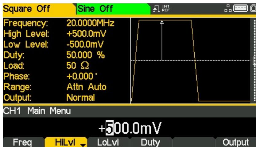
Beachten Sie, dass durch wiederholtes Drücken des Softkeys Ampl die Beschriftung der Tasten Ampl und Offset auf HiLvl (High-Level) und LoLvl (Low-Level) wechselt und umgekehrt.
