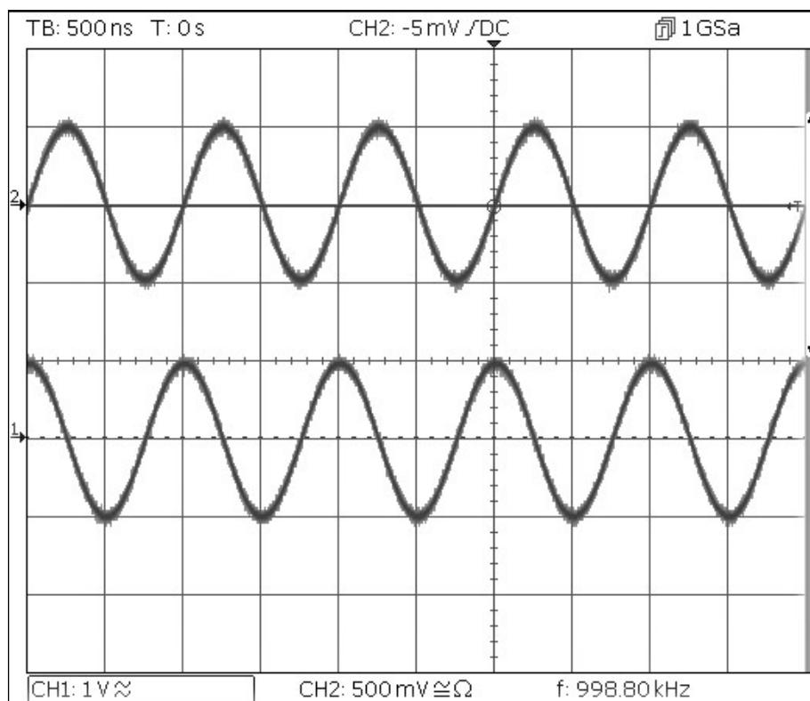
Beachten Sie, dass, wenn Kanal 1 auf 1MHz eingestellt wird, Kanal 2 ebenfalls auf 1MHz eingestellt ist. Die 90-Grad-Phasenverschiebung zwischen den Kanälen ist zu erkennen.
