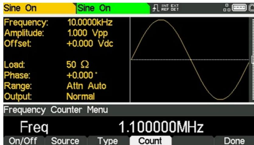
La caja de edición muestra la medición actual. Cuando no existe ninguna señal presente en la entrada seleccionada, el contador indica No signal (sin señal) hasta que se aplique la señal adecuada.
