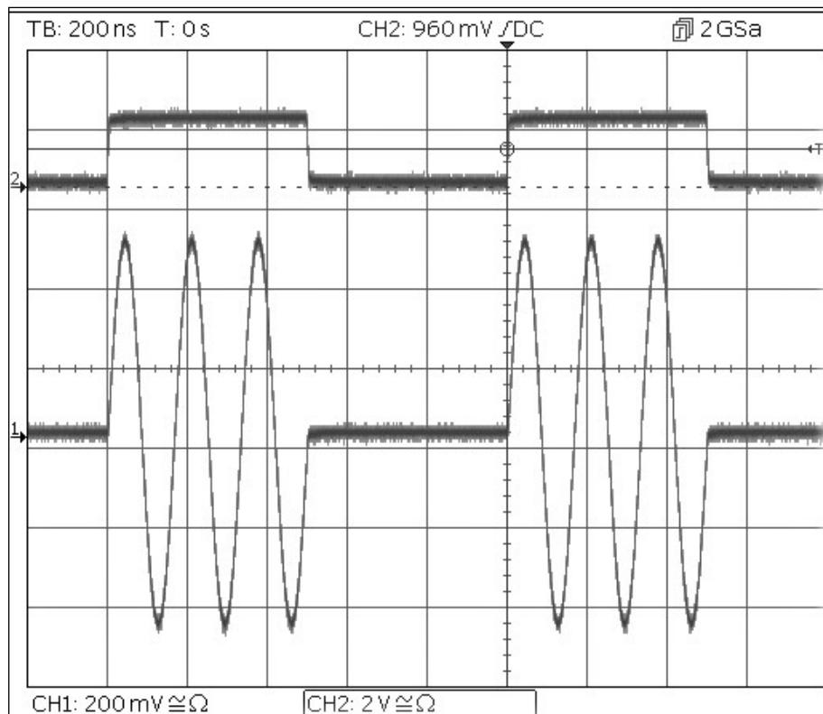
Advierta que la segunda traza representa la salida de la toma Main Output 2 cuando el canal 2 está sincronizado: dicha salida sigue la señal de entrada de activación.
