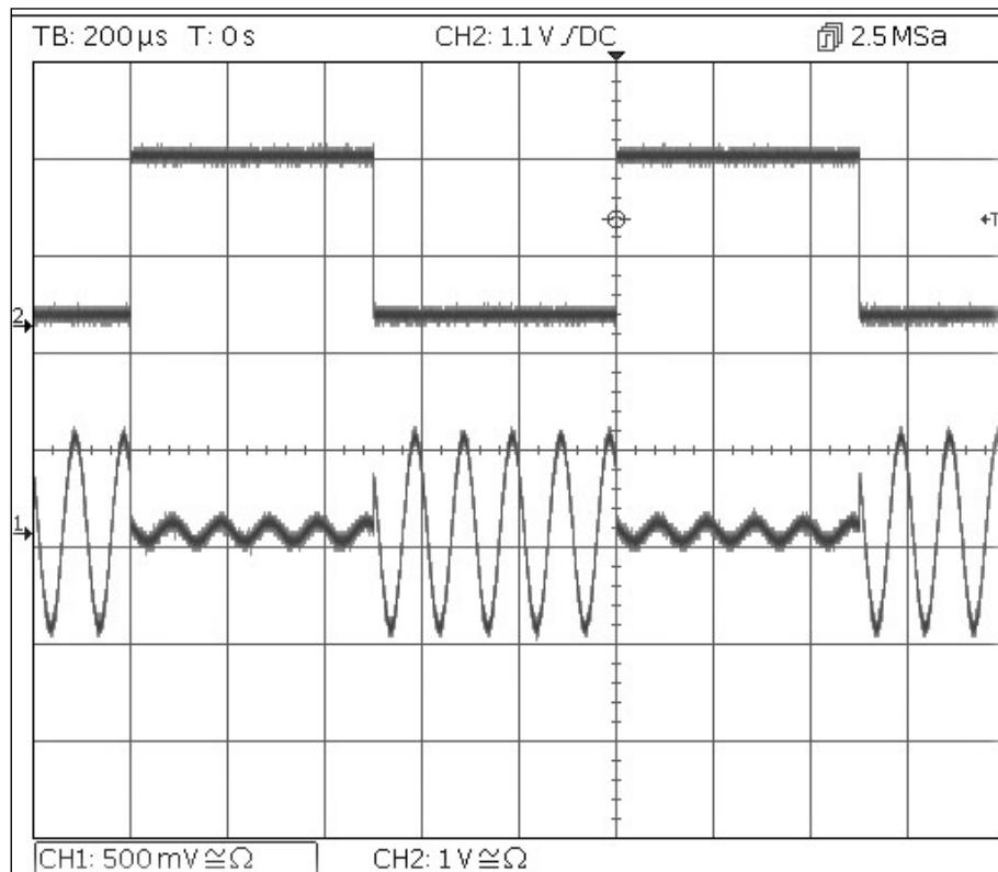
Advierta que la segunda traza representa la salida de la toma Main Output 2 cuando el canal 2 está sincronizado: dicha salida sigue la señal de la onda moduladora.
