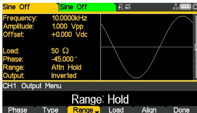
El modo Auto varía automáticamente el intervalo en pasos de 6 dB de atenuación (es decir, máximos de intervalo de 10 Vpp, 5 Vpp, 2,5 Vpp, etc., en 50 Ω), con el intervalo de calibrado de la amplitud limitado a 6 dB para mantener la calidad de la forma de onda.
