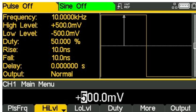
Le successive pressioni del soft-key **Ampl** cambiano le etichette dei tasti **Ampl** e **Offset** in **HiLvl** (livello alto) e **LoLvl** (livello basso) e viceversa.
