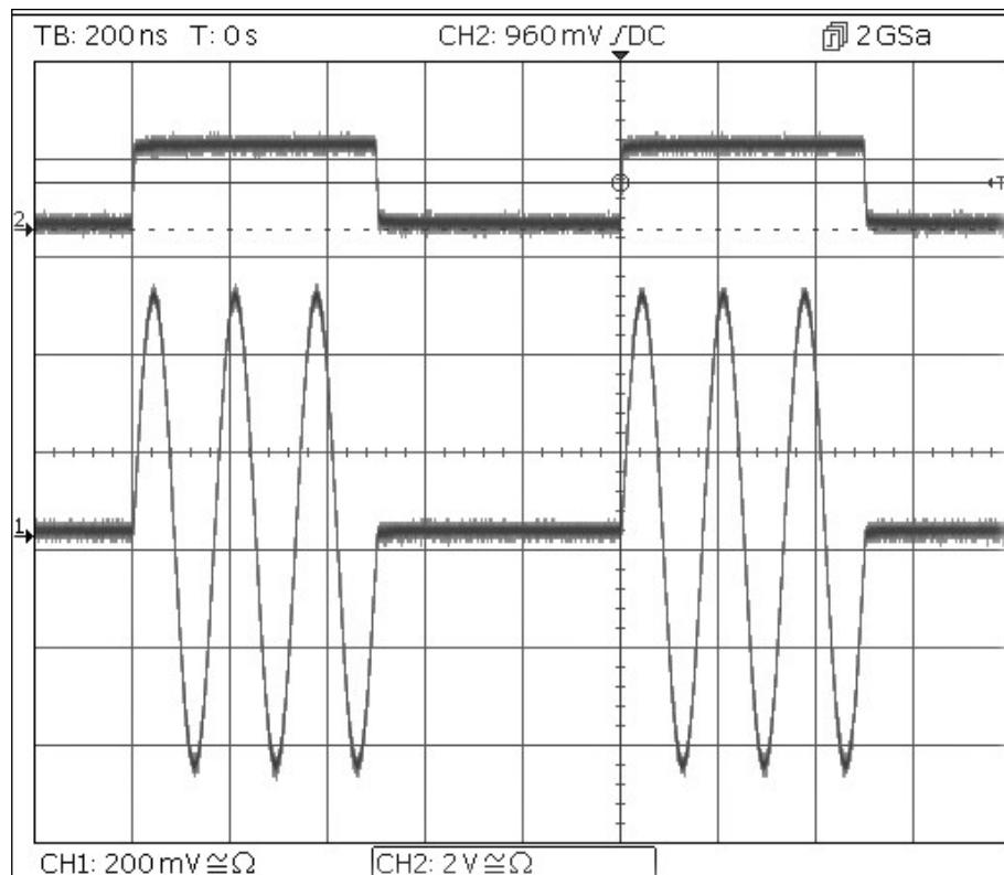
Notez que le deuxième tracé est la sortie de la prise Main Output 2 (Sortie principale 2) lorsque la voie 2 est synchronisée, qui suit le signal d'entrée de déclenchement.
