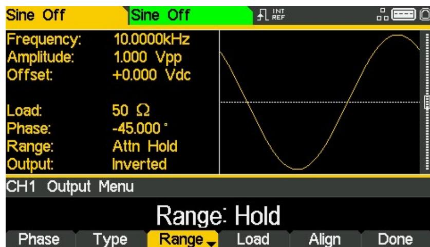
Die Spannungsautomatik verläuft in Dämpfungsschritten von jeweils 6dB (d. h. 'Range') Maximalwerte von 10 Vpp, 5 Vpp, 2,5 Vpp etc. an  $50\ \Omega$ ), wobei die Feineinstellung der Amplitude auf 6dB begrenzt ist, um die Güte der Wellenform zu erhalten. Durch Wahl von Hold wird die automatische Bereichswahl deaktiviert. Die Dämpfungseinstellung ist fixiert und die Feineinstellung der Amplitude nicht länger begrenzt.
