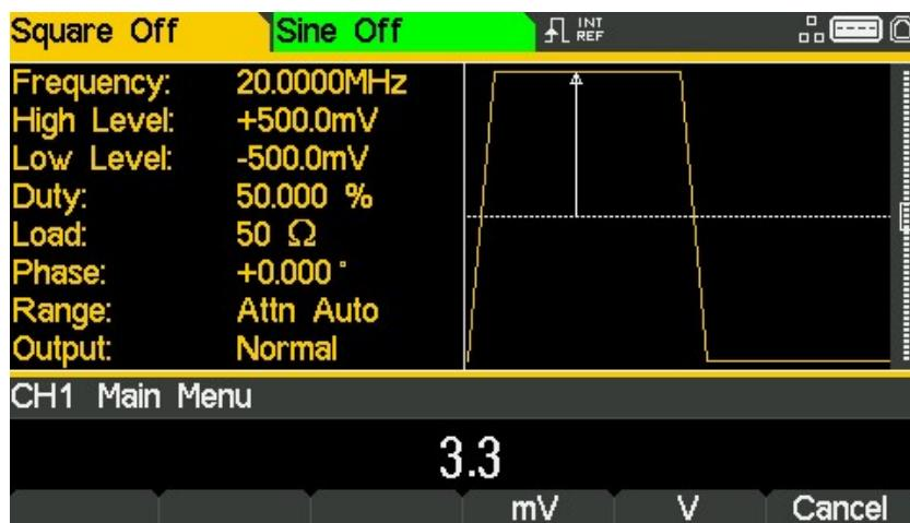
Sobald eine Zahl eingegeben wird, ändern sich die Softkeys und zeigen Spannungseinheiten an.
