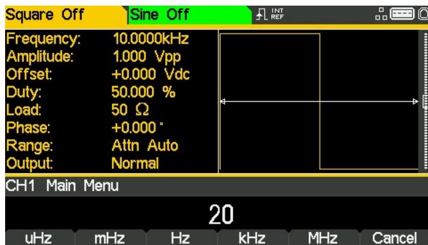
Sobald eine Zahl eingegeben wird, ändern sich die Softkeys und zeigen Frequenzeinheiten an.
