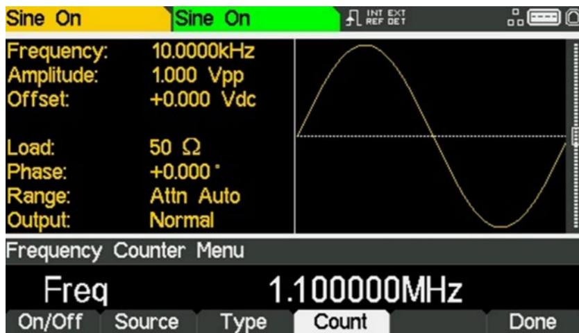
Der Editerbereich zeigt die aktuelle Messung. Wenn am ausgewählten Eingang kein Eingangssignal anliegt, zeigt der Zähler „No signal“ an, bis ein entsprechendes Eingangssignal anliegt.
