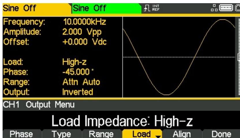
Beachten Sie, dass die Standard-Lastimpedanz 50 Ohm beträgt, jedoch auf eine beliebige Impedanz zwischen 50 und 10.000 Ohm eingestellt werden kann. Die Pegel werden auf der Grundlage dieser Impedanz berechnet. Beachten Sie, dass wiederholtes Drücken der Taste **Load** einen Wechsel zwischen einem numerischen Wert und „High-z“ bewirkt. Beachten Sie, dass sich der angezeigte Amplitudenwert auf 2 Volt pk-pk erhöht.
