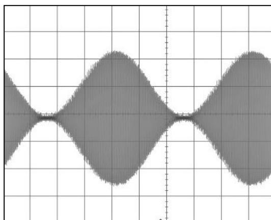
Changer la modulation et la régler sur AM-SC
