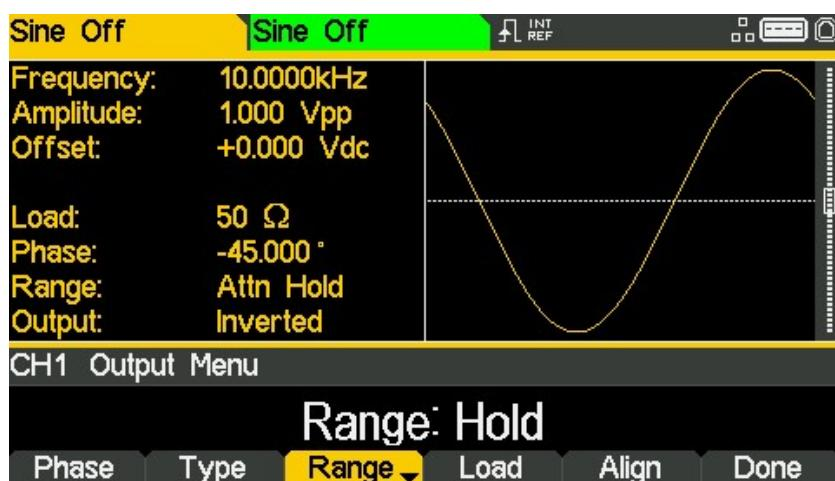
Le mode Auto règle la gamme automatiquement par pas de 6 dB d'atténuateur (c.-à-d. 'gamme' maximum de 10 Vpp, 5 Vpp, 2,5 Vpp, etc., à 50 Ω), avec une gamme du vernier de réglage de l'amplitude limitée à 6 dB afin de maintenir la qualité de la forme d'onde.
