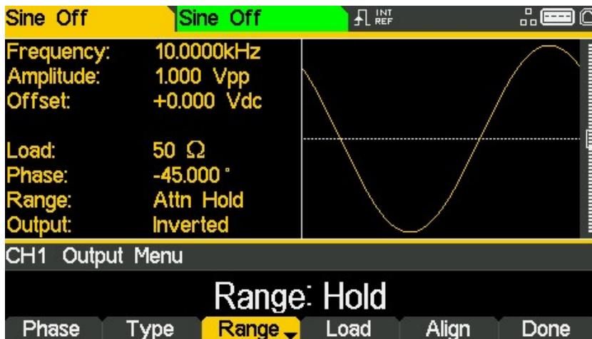
La modalità Auto esegue automaticamente la calibrazione in incrementi dell'attenuatore da 6dB (ovvero, valori massimi dell'intervallo di 10Vpp, 5Vpp, 2,5Vpp ecc. in 50Ω), con l'intervallo Vernier dell'ampiezza limitato a 6dB per mantenere la qualità della forma d'onda.
