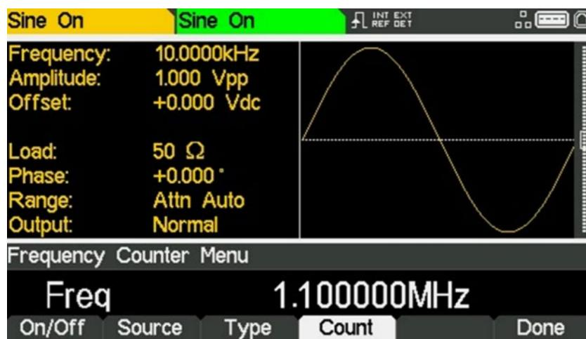
La fenêtre Modification affiche la mesure actuelle. Sans la présence d'un signal d'entrée à l'entrée sélectionnée, le compteur affiche « No signal » jusqu'à ce qu'un signal d'entrée adéquat soit appliqué.
