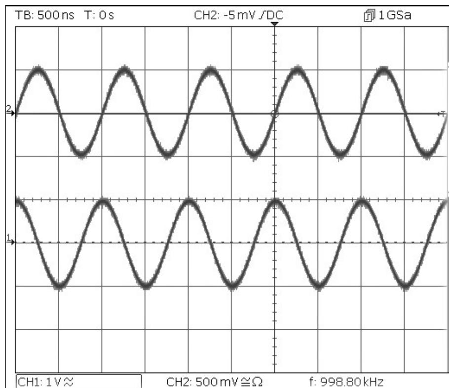
Veuillez noter que lorsque la voie 1 est réglée sur 1MHz, la voie 2 est également réglée sur 1MHz. Il est possible d'observer le changement de phase de 90 degrés entre les voies.
