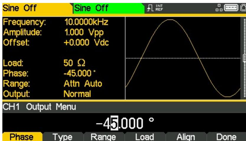
El ángulo de fase configurado es el punto del periodo de la forma de onda que coincide con el flanco de activación o sincronismo; es decir, el punto del periodo en el que comienza la forma de onda. Consecuentemente, al configurarse una fase negativa, la forma de onda se adelanta, mientras que con una fase positiva se retrasa, con respecto a la activación o el sincronismo; la forma de onda de la caja de gráficas se actualiza para mostrar este cambio.
