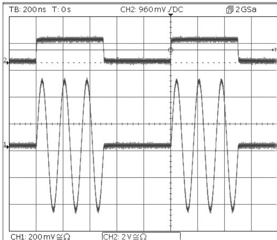
Notare che la seconda traccia è l'uscita dal socket principale dell'uscita 2 quando il canale 2 è sincronizzato, che segue il segnale di forma di ingresso trigger.
