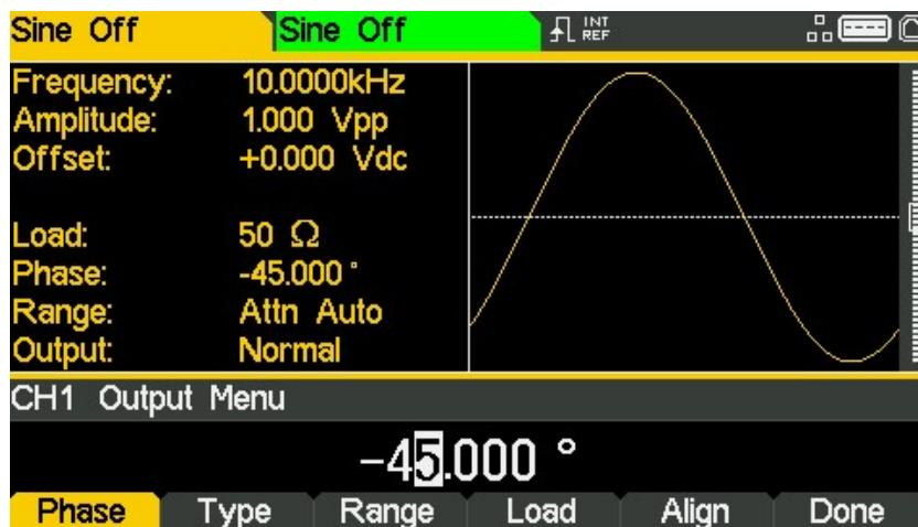
Der eingestellte Phasenwinkel ist der Punkt in der Wellenformperiode, der mit dem Sync oder der Triggerflanke übereinstimmt, d. h. es ist der Punkt in der Periode, an der die Wellenform beginnt. Daher eilt eine negative Phaseneinstellung voraus, während eine positive Phaseneinstellung die Wellenform in Bezug auf den Sync oder Trigger verzögert. Dies wird auch im Grafikbereich angezeigt.
