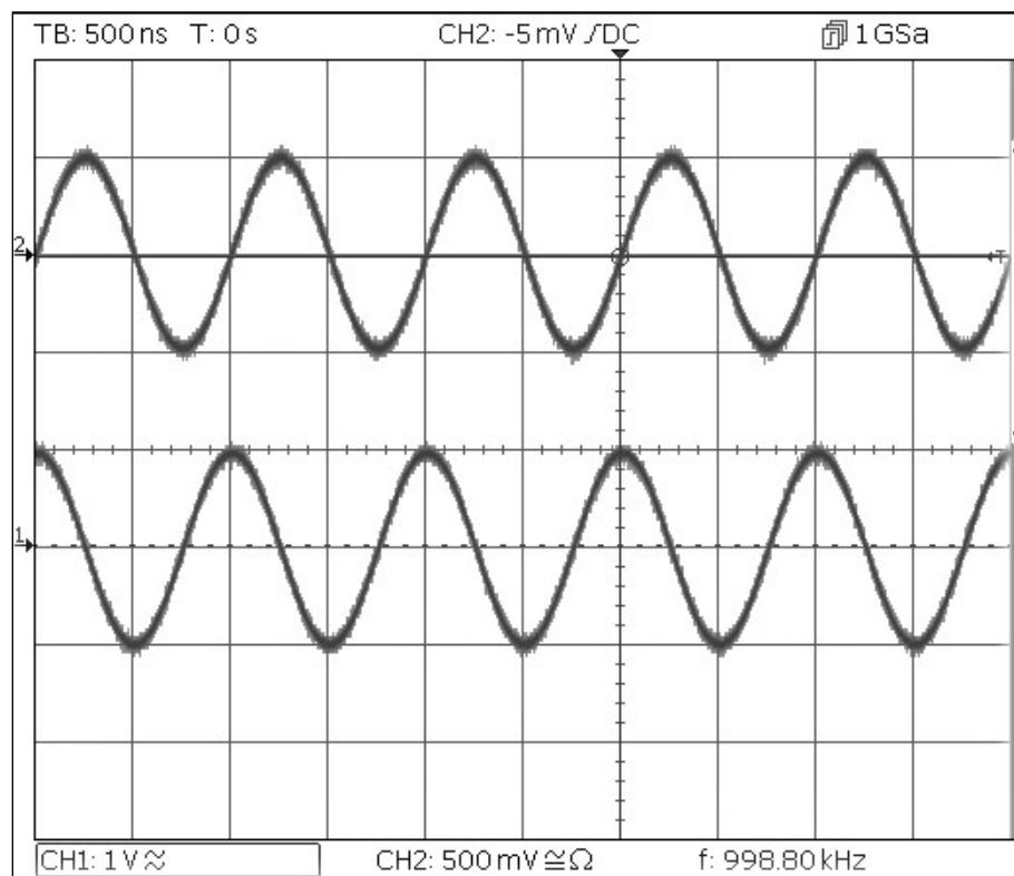
Observe cómo, al configurar el canal 1 a 1MHz, el canal 2 también se configura a 1mHz.
