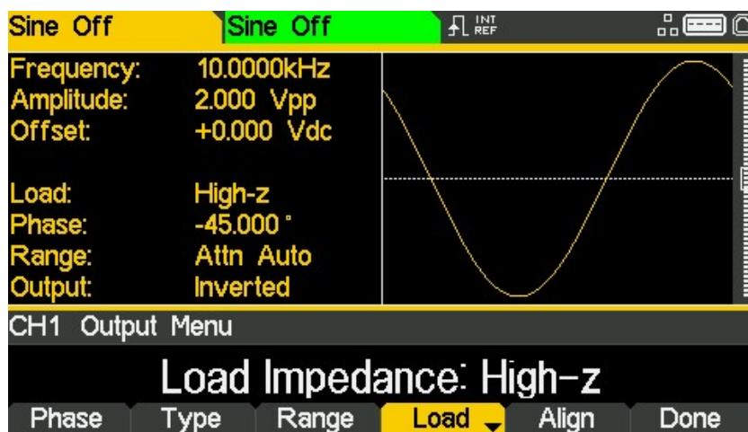
L'impedenza di carico predefinita è 50 Ohm, ma può essere modificata in qualsiasi valore compreso tra 50 e 10.000 Ohm. I livelli sono calcolati in base a questa impedenza.
