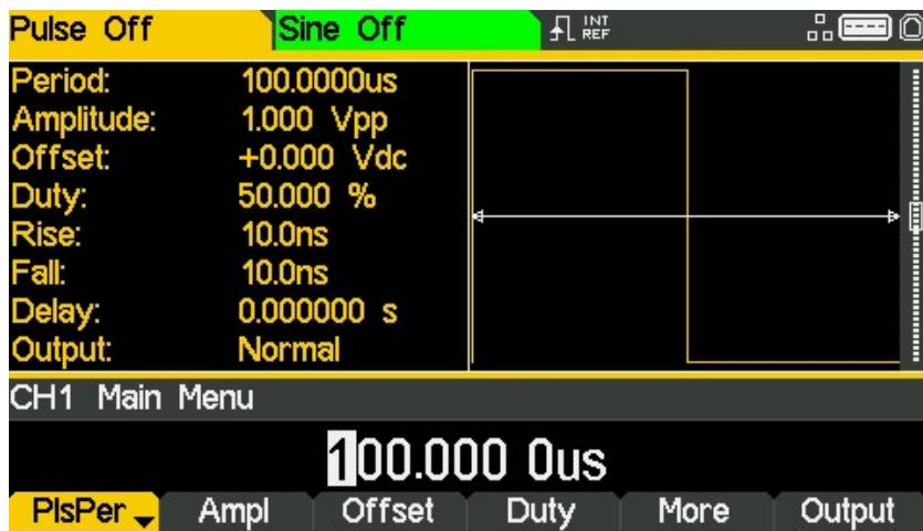
Durch wiederholtes Drücken dieses Softkeys die Funktion zwischen Frequenz und Periode wechselt.
