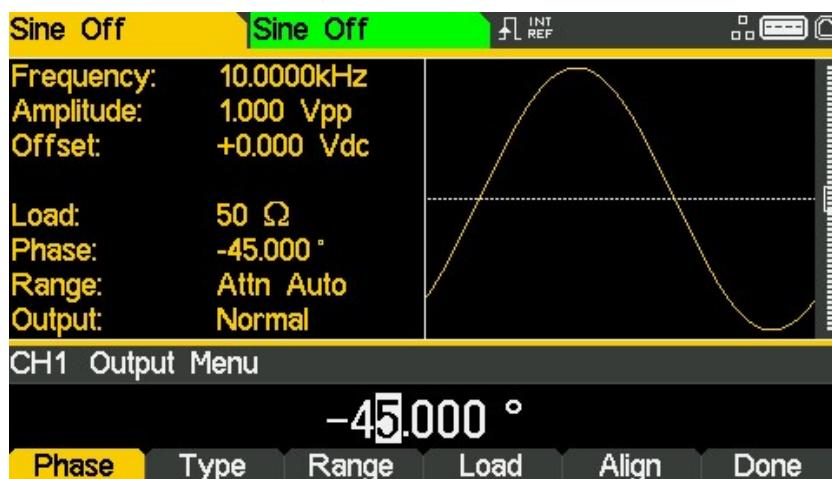
L'angle de phase réglé est le point de la période de la forme d'onde qui coïncide avec le front de synchronisation ou de déclenchement. Autrement dit, il s'agit du point de la période auquel commence la forme d'onde. C'est pourquoi un réglage de phase négatif avance, et un réglage de phase positif retardé la forme d'onde par rapport à la synchronisation ou au déclenchement ; la forme d'onde présentée dans la fenêtre graphique change pour illustrer cet état de fait.
