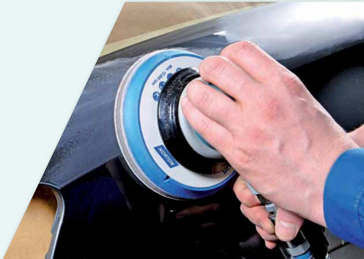
Die selbstklebenden Hochleistungsschleifscheiben von Norton können sicher auf entsprechenden Stütztellern befestigt werden. Selbstklebende Norton Pro A275 Scheiben werden in einem bequemen Spender mit Rollen à 100 Stück geliefert.
