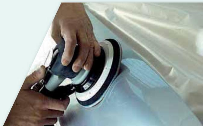
Norgrip® und Soft-Touch Scheiben haben ein Schnellbefestigungssystem für den schnellen und einfachen Scheibenwechsel zur Leistungssteigerung durch Reduzierung der Stillstandzeit. Soft-Touch Scheiben haben eine Schaumstoffunterlage, die die Leistung verbessert bei gleichzeitig längerer Produktlebensdauer. Die Schaumstoffunterlage gleicht Unebenheiten auf der Oberfläche aus, vereint eine exzellente Abtagsrate mit einem sehr homogenen, hochqualitativen Endergebnis.
