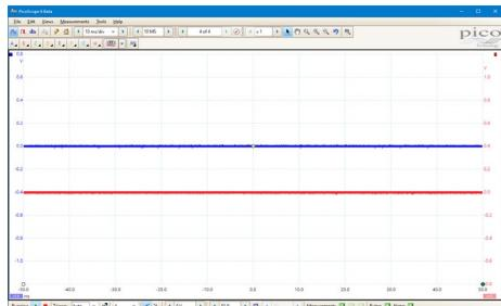
1.首次启动带有 TA369 MSO Pod 的 PicoScope 6 时,将只能看到模拟通道。
