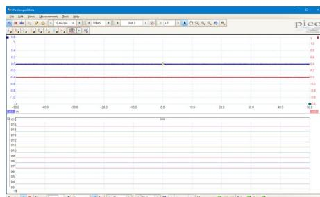
5.单击启用所有,然后单击确定。PicoScope 显示器随后将改变为显示所选的数字输入。
