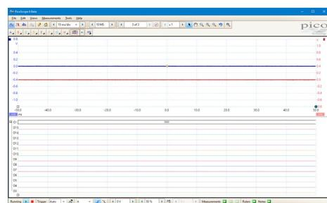
5. Klicken Sie **Alle aktivieren**, dann **OK**. Das PicoScope-Display wechselt dann zur Anzeige der ausgewählten digitalen Eingänge.
