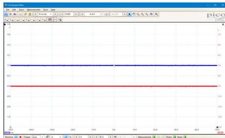
1. Quando si avvia PicoScope 6 con un TA369 pod MSO per la prima volta, saranno visibili solo i canali analogici.
