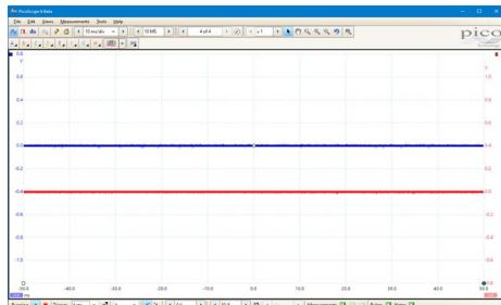
1. Cuando inicie PicoScope 6 con un módulo para MSO TA369 por primera vez, solo serán visibles los canales analógicos.
