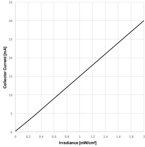
Testcondition: Ee= 0,5 mW/ cm<sup>2</sup>; VCE=5V
