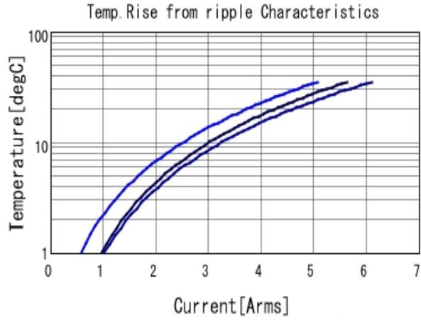
GRM219R61C226ME15 Temp. rise ■ 80kHz ■ 400kHz ■ 800kHz
